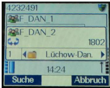
Bestätigung mit der Sendetaste oder einfach warten, automatische Umschaltung auf die neue Gruppe erfolgt nach 5 Sekunden
