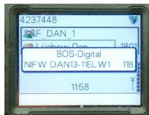
Während des Einschaltvorgangs wird auch die OPTA des Gerätes kurz angezeigt
